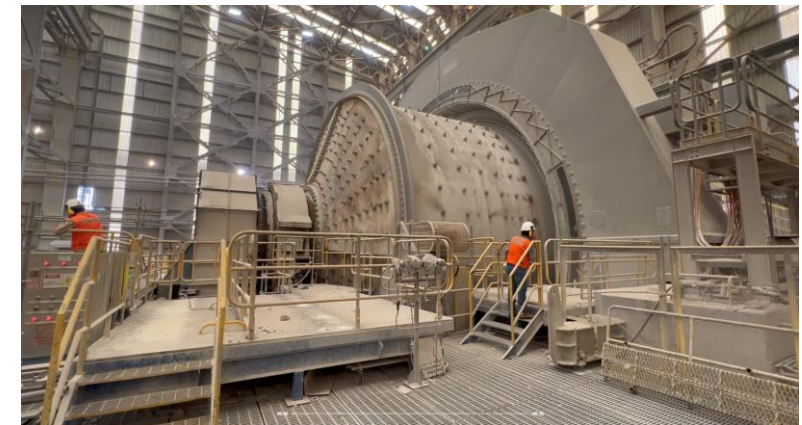
Molino SAG (semiautógeno), DMH CODELCO, 2023. Foto: FF
